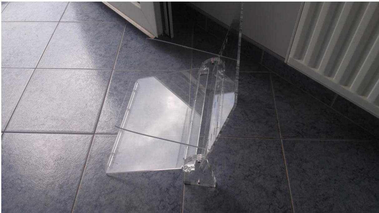
Slika 8: 18.4.2019: Razvoj prototipov je sledil v smeri ustvarjanja modela velikosti A4 iz pleksi stekla, ki ima določene prednosti tako pri izdelavi kot uporabi modela. Nastal je model, ki ima možnih več kotov vstavljanja spodnje plošče v stojalo, prav tako pa več višin zgornjega naslovna. Model ima dodano dodatno ploščo za odlaganje prenosnega računalnika. Prav tako so dodane zagozde, ki sestavljen model učvrstijo v stabilno kompozicijo.
