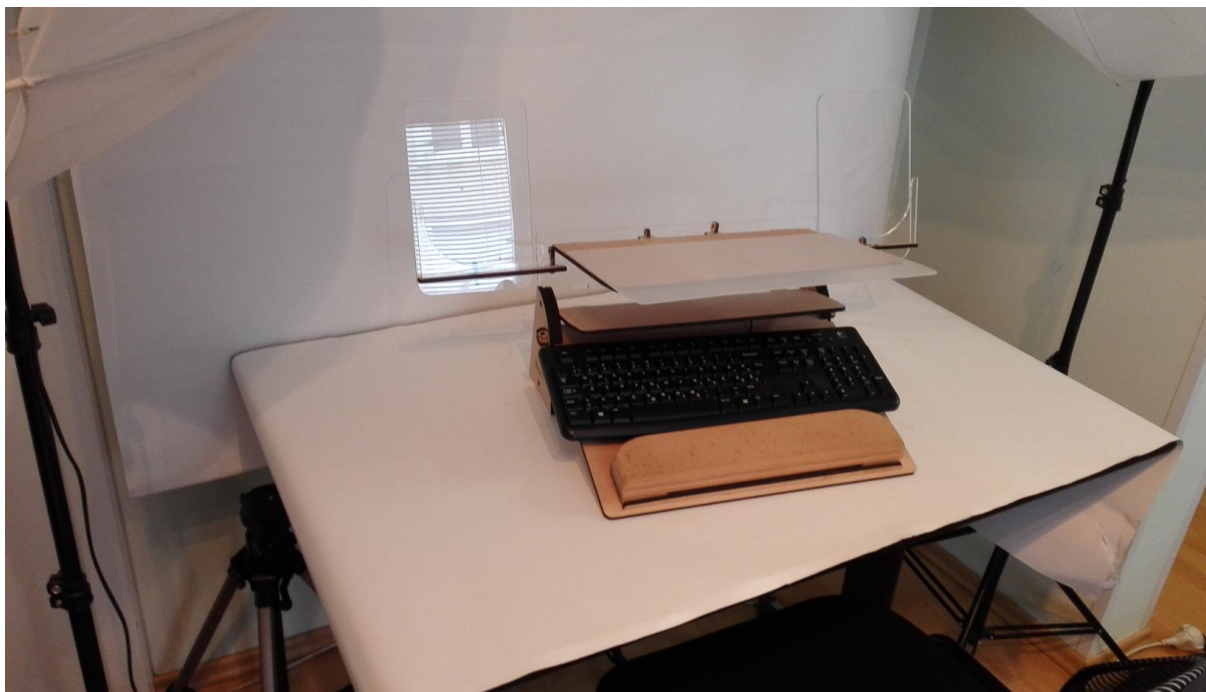
Slika 13: 29.5.2019: Nadaljnji razvoj podpira preostale tehnologije, ki so pogosto del dela v pisarni: dodana je polička z naslonom za mobilni telefon, ter polička z naslonom za tablico.
