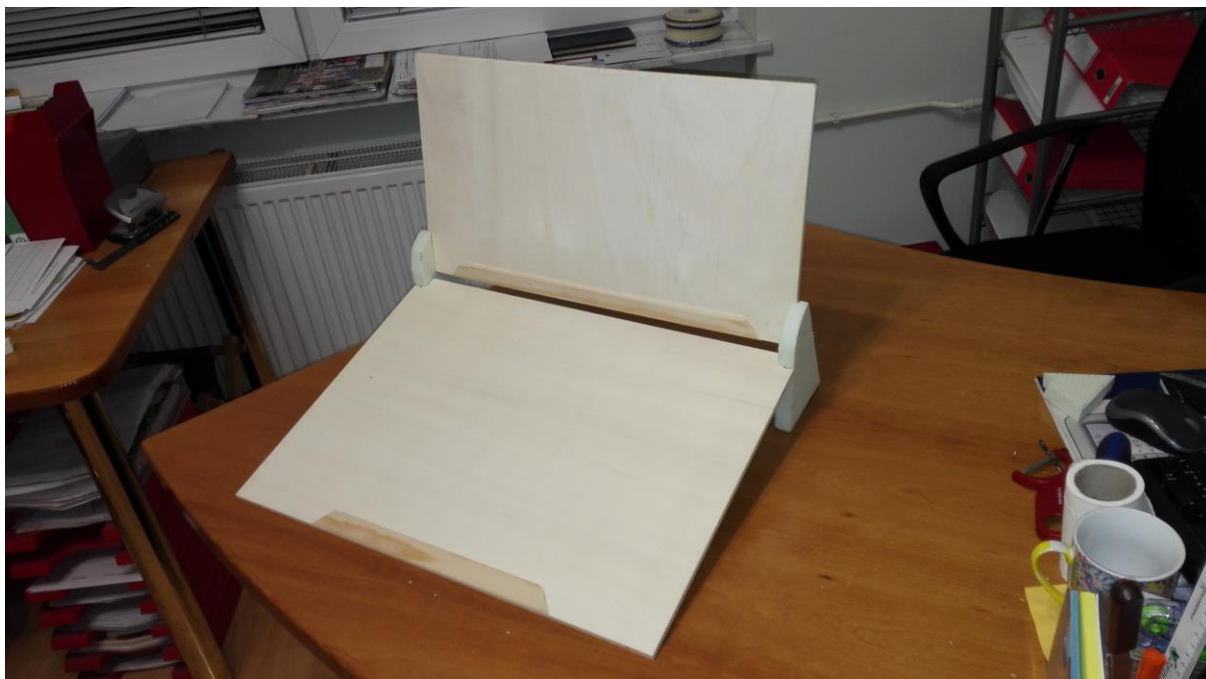
Slika 1: 28.8.2018: prvi prototip velikosti A3, ravnih površin, fiksno montiran na en kot spodnje plošče in en kot zgornjega naslona. Model ima ozke police za odlaganje listov, knjig.
