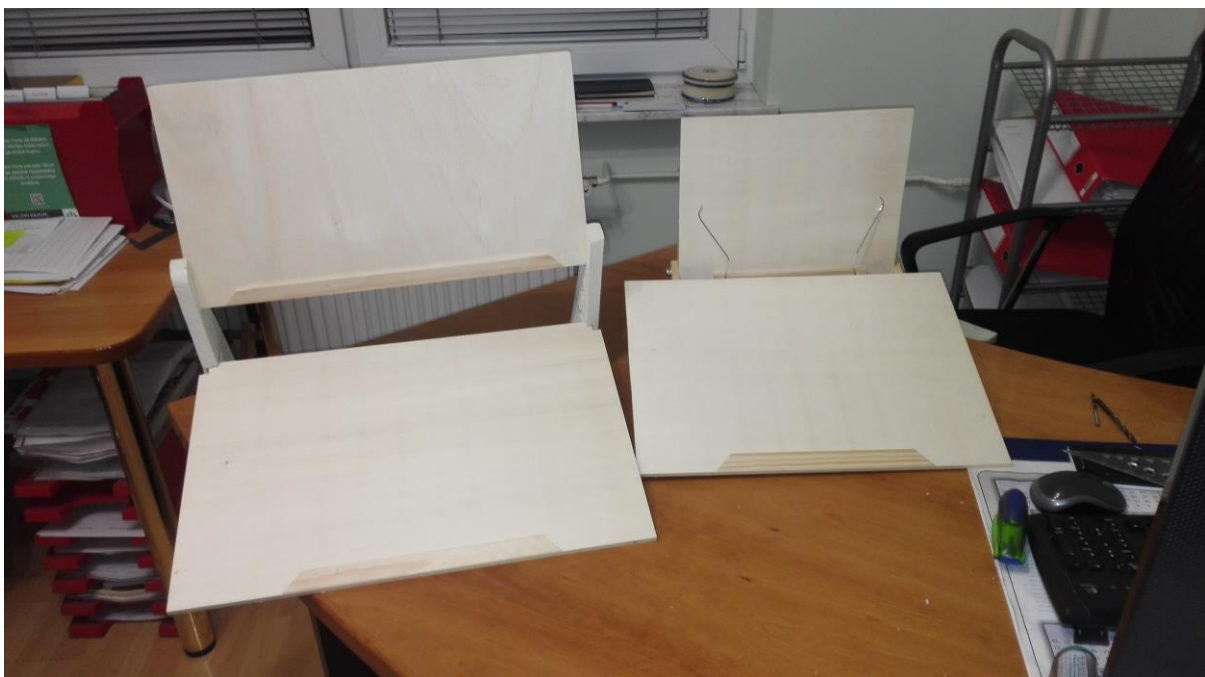
Slika 3: 29.8.2018: tretji prototip, ravnih površin, fiksno montiran na en kot spodnje plošče, s tehnologijo z več možnimi nakloni fiksiranja zgornjega naslona. Model ima ozke police za odlaganje listov, knjig ter sistem pričvrstitve zgornjega dela z namenom, da knjige na zgornji polici stojijo fiksno.
