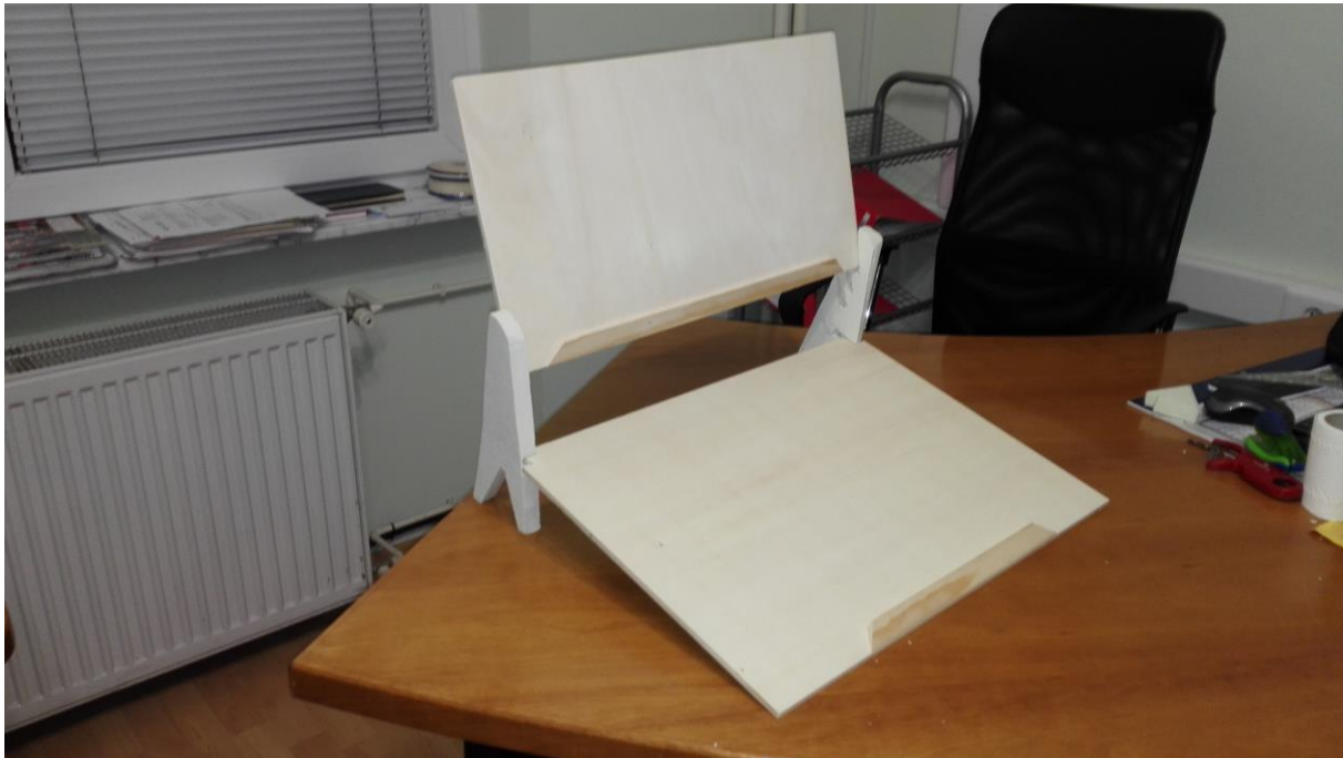
Slika 2: 29.8.2018: drugi prototip velikosti A3, ravnih površin, fiksno montiran na en kot spodnje plošče, z več možnimi višinami pripenjanja zgornjega naslona. Model ima ozke police za odlaganje listov, knjig.
