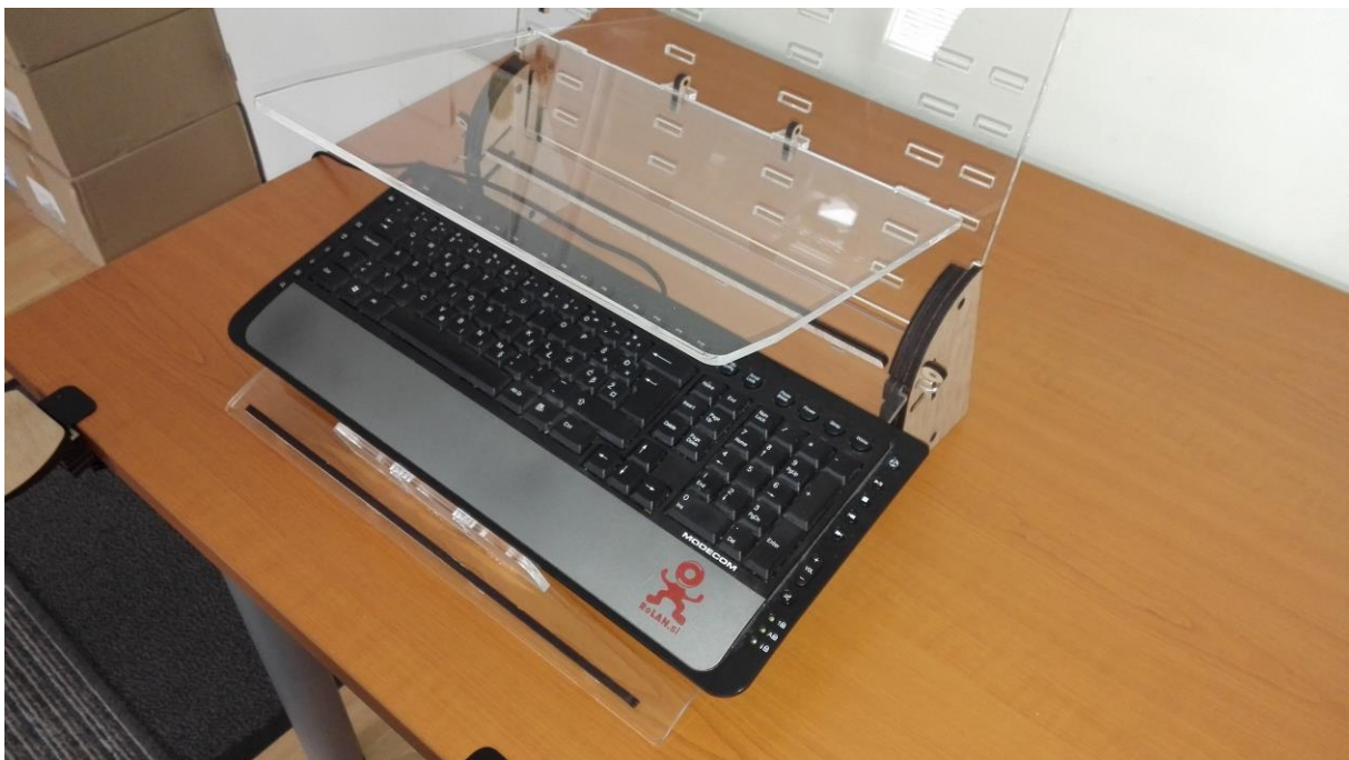
Slika 12: 6.5.2019: Posodobljena varianta nosilca tipkovnico, ki ima sprednjo ravno površino za naslon za roke že dodano. Možno jo je pozicionirati na poljubno razdaljo, glede na to, kakšno tipkovnico uporabljamo. Iz zgornje plošče je razvidno, da so dodane odprtine, ki nudijo možnosti pripenjanja odlagalne površine (za prenosni računalnik, liste,...) na višino, ki ustreza višini telesa.
